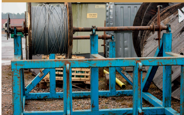
Kabeltrumbock för 3 st trummor med maskinfäste
